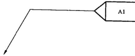
图 A.4 封闭尾部示例
